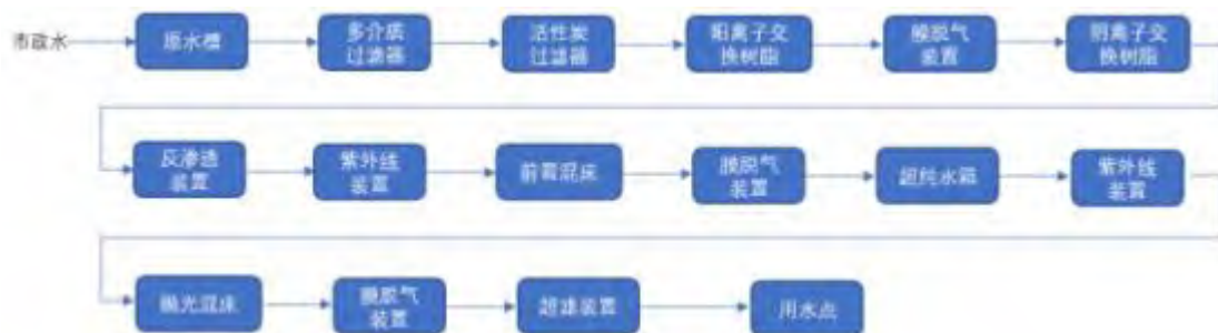
图 2-15 纯水制备工艺及产污流程图
