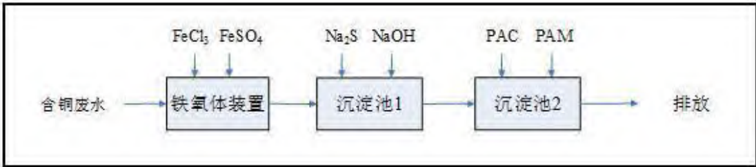
图 2-22 含铜废水处理工艺流程图
