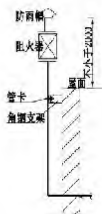
氢气放空管示意图
